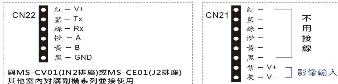
MS-I10V-CA接線圖(搭配MS-C18系列說明)：
