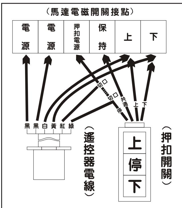
**押扣電源須切掉，然後遙控器電線之紅色線接馬達端切口，綠色線接押扣開關端切口。**
