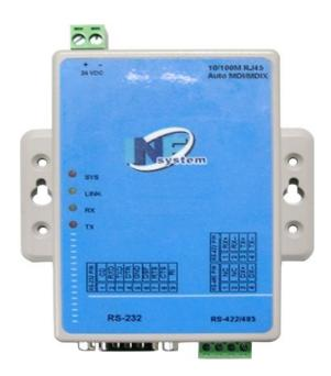
TW-9500 門禁管制系統在連線狀態下各門禁主機是以 RS-485 通訊連線後; 再藉由本通訊介面器將 RS-485 訊號轉換為乙太區域網路訊號進入遠端電腦主機。
